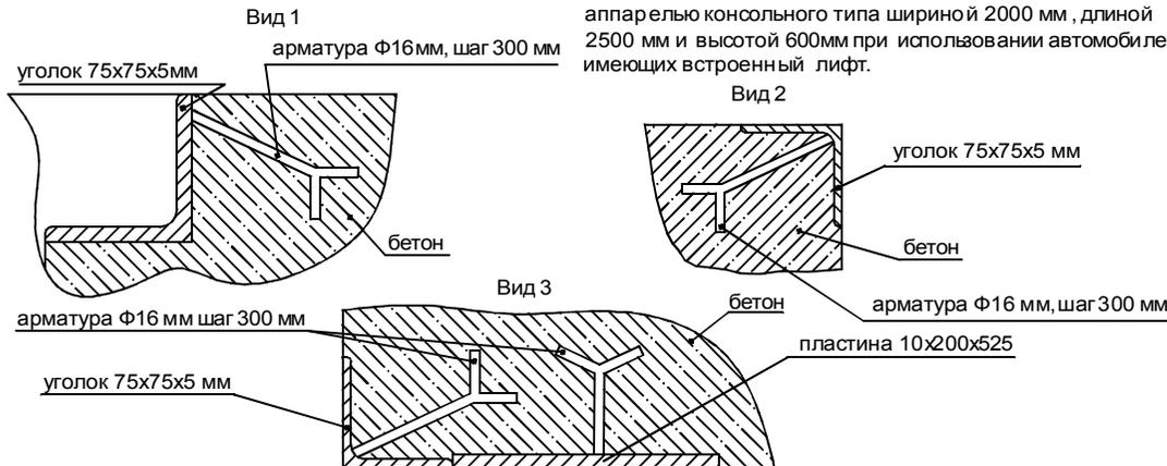
Данная схема подготовки приямка и установки закладных элементов под уравнительную платформу с поворотной аппаратурой консольного типа шириной 2000 мм, длиной 2500 мм и высотой 600мм при использовании автомобилей, имеющих встроенный лифт.
